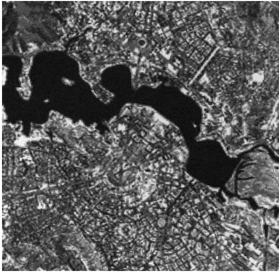
Image BO-13: Une étendu d'eau à Cambera, Australie, vue dans l'IR proche seulement. Notez que l'eau y apparaît en noir. Source: EROS Data Center
