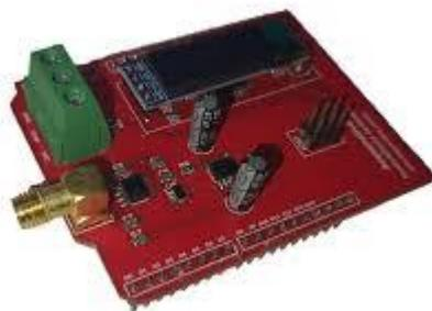
**Figura 11- Placa Shield pH**
