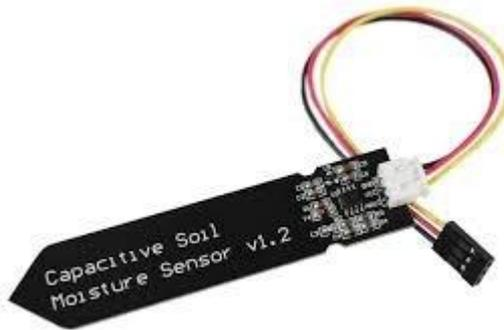
**Figura 3 – Sensor de Capacitância**
