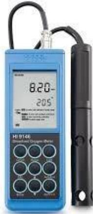
**Figura 8 – Medidor de Oxigênio Dissolvido**
