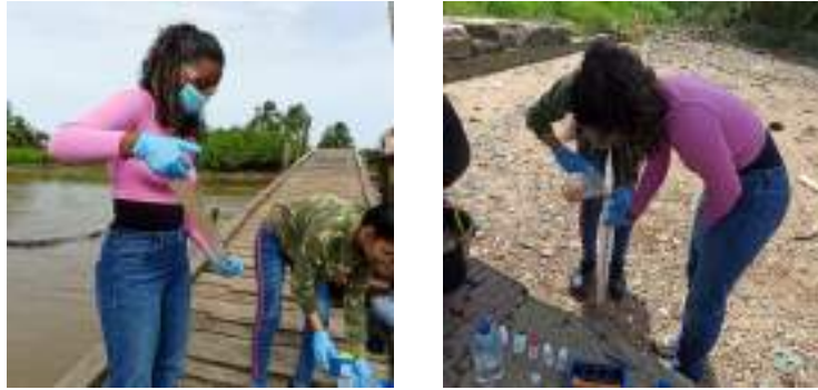
Fig. 1.6: Werken met de secchi-buis.
