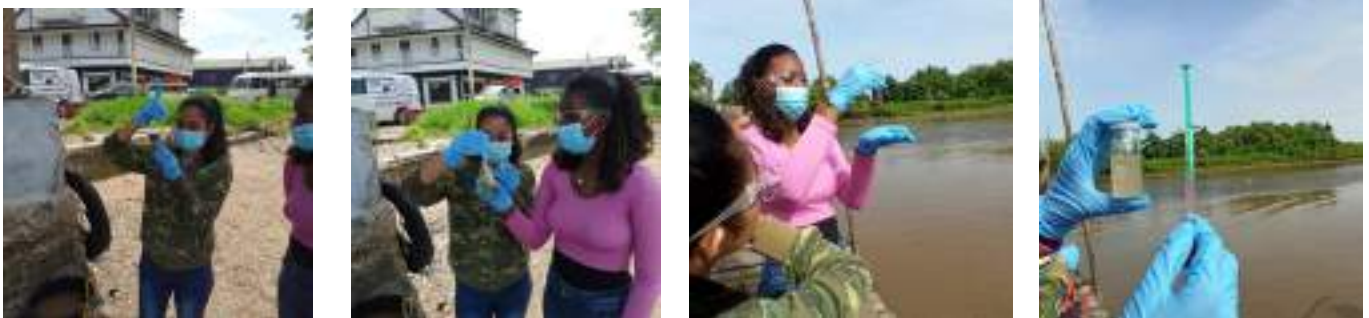
Fig. 1.5: Het meten van de opgeloste zuurstof (D.O.)
