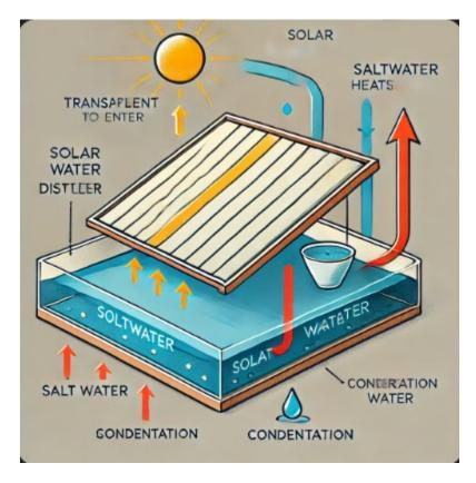
Esquema del Sistema Desalinizador simplificado sin su electronica de monitoreo.
