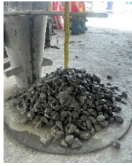
ภาพที่ 4 แสดง Slump คอนกรีตที่มีทรายหรือหินฝุ่นผสม
