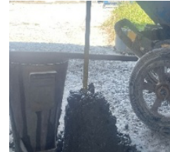
ภาพที่ 5 แสดง slump คอนกรีตทั่วไป(ใช้ทราย)
