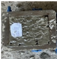
ภาพที่ 3 แสดงคอนกรีตที่ไม่มีทรายหรือหินฝุ่นเป็นส่วนผสม
