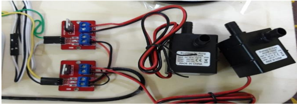
رسم توضيحي 11 : وحدات الـ MOSFET Driver بعد
