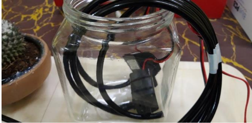
رسم توضيحي 14: أنابيب السيليكون والمضخات داخل الوعاء الزجاجي.
