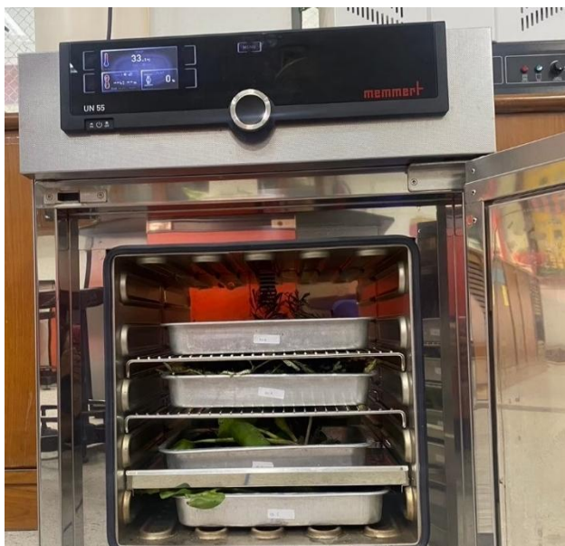
ภาพที่ 3.12 การอบแห้งตัวอย่างพืช ด้วยตู้อบลมร้อน
