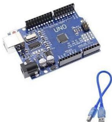
**Figura 7 – Placa Arduino UNO e Cabo USB Arduino**
