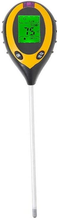
مقياس رطوبة التربة مع اداة قياس الحموضة وضوء الشمس
