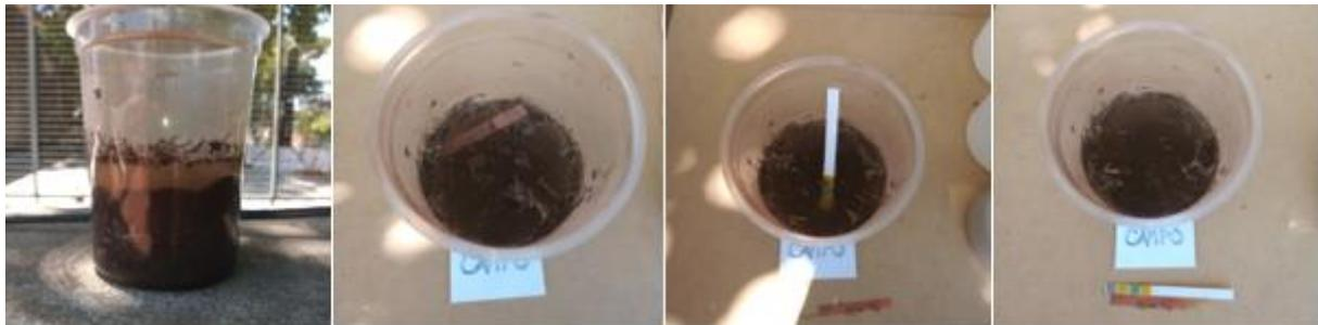
Figura 20: Pruebas con tiras de pH de dos tipos diferentes en la muestra de la zona rural de Pujato (Muestra 5)
