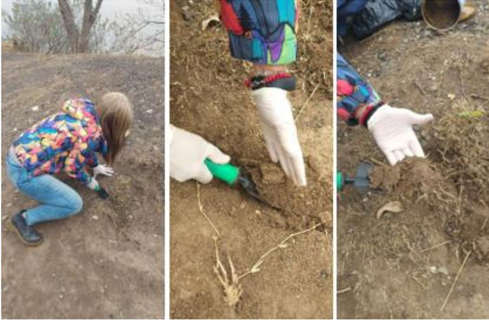
Figura 15: Extracción de muestra de suelo en la barranca
