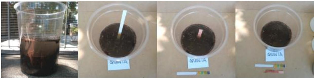
Figura 19: Pruebas con tiras de pH de dos tipos diferentes en la muestra de la huerta familiar (Muestra 4)
