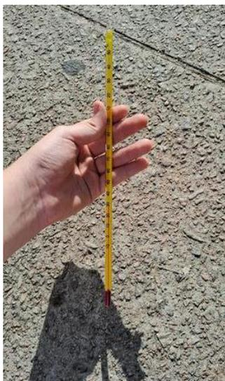
Fig.1 - Termômetro químico com escala externa
