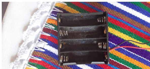
Ilustración 6 Porta baterías (fotografía A. López)
