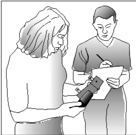
1. Verbindet ein digitales Voltmeter mit den Ausgängen eures Sonnen-Photometers. (Analoge Voltmeter sind wegen ihrer Ungenauigkeit für diese Messung nicht geeignet.) Gebt Acht, dass ihr die Prüfspitzen des Voltmeters in die entsprechenden Ausgänge des Photometers steckt: rotes Kabel (+) auf rote Buchse, schwarzes Kabel (-) auf schwarze Buchse. Wenn das Photometer über ein eingebautes Voltmeter verfügt, könnt ihr diesen Schritt überspringen.
