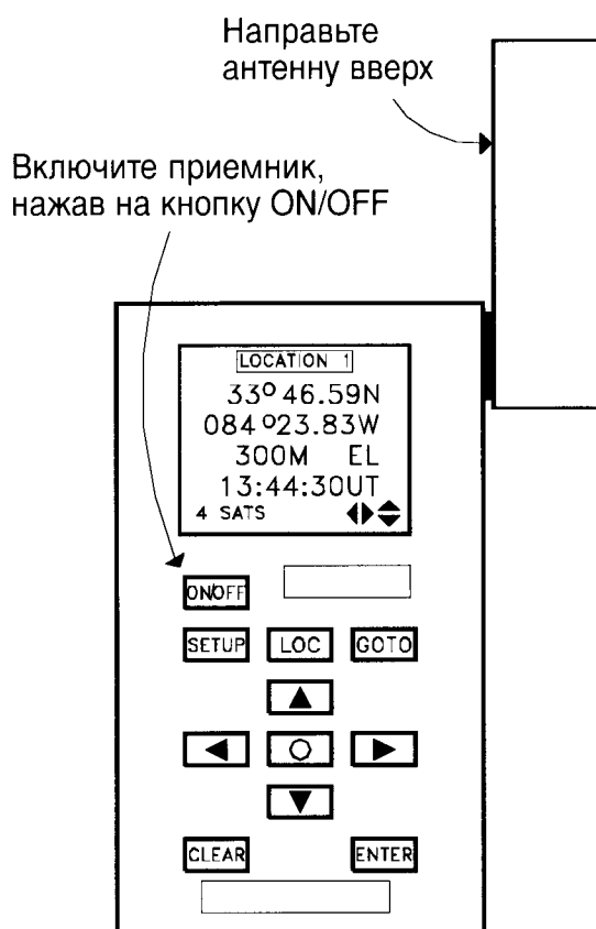
Рис. GPS-P-2. Схема одного из приемников GPS.
