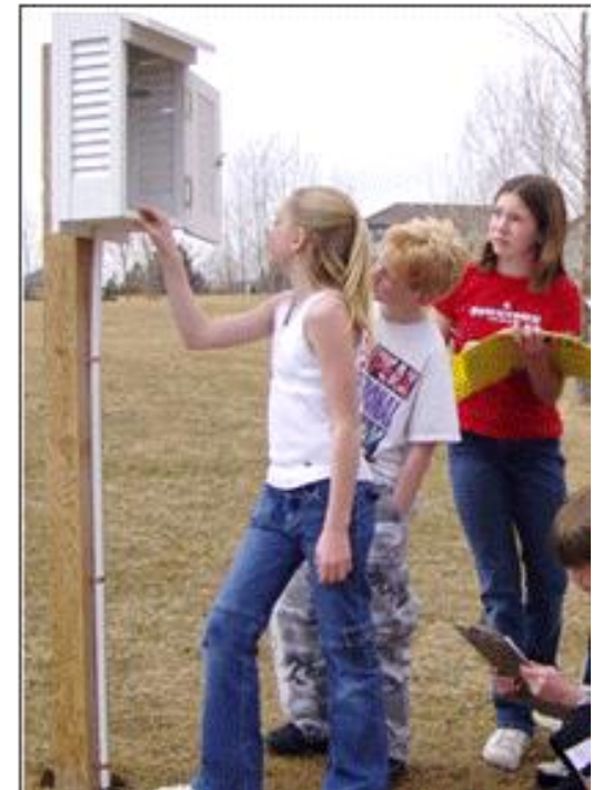
Abrigo para Instrumentos Instalado
