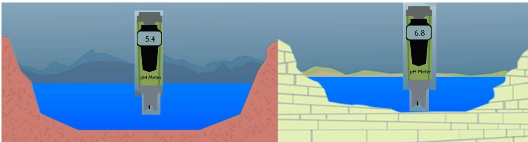
*Dois lagos hipotéticos e um medidor de pH. O lago à direita é cercado por calcário, que intemperizam para produzir íons de carbonato e de bicarbonato. Esses aumentam a alcalinidade da água. O lago à esquerda é formado por rocha ígnea, que não produz carbonatos quando intemperizada. O lago à direita é resistente a mudanças quando ácido é adicionado, enquanto o lago à esquerda muda mais rapidamente.*
