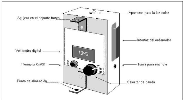
El diagrama muestra un instrumento rectangular con un panel digital en el centro que muestra el número '1.345'. A la izquierda del panel hay un interruptor rotativo y un agujero en la parte superior. A la derecha hay una interfaz de computadora y un selector de banda. En la parte inferior hay un punto de alineación y un enchufe. Hay también un agujero en la parte superior para la luz solar.
