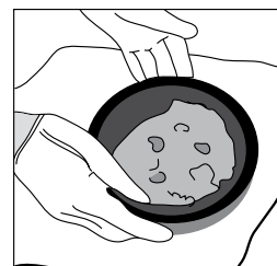
Image 9, pour sample through sieve
