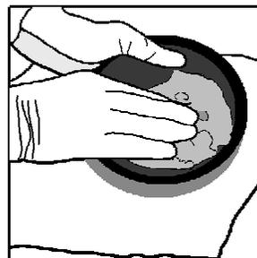
9. Se presiona muy levemente empujando el suelo seco por la malla. Hay que tener cuidado de no forzar los agujeros de la malla al presionar. Las rocas no podrán pasar por la malla. Si no hubiese un tamiz, se quitan las rocas con la mano. Guarda el suelo tamizado de cada muestra para otros análisis de laboratorio.
